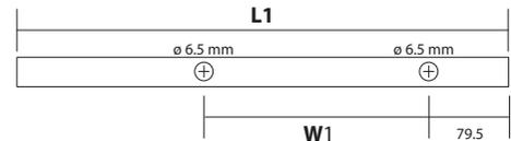
hacer 2 barrenos en el riel como se muestra en el dibujo para los conectores a cristal
